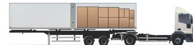
Távirányító vezéreléssel a hátsó felépítmény elmozdul a vezetőfülké felé. Ezzel egy időben a nyergesvontató alváza automatikusan meghosszabbodik.
