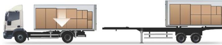
A felépítmény előrefelé mozdul és automatikusan rögzül szintén a távirányító segítségével. A tehergépkocsi készen áll, hogy megkezدje az első körfutrott.
